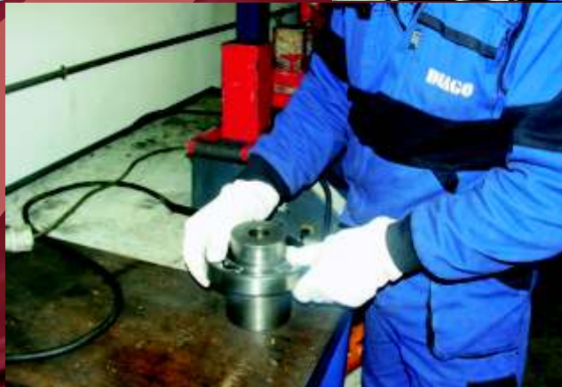
- Montáž ložísk pomocou indukčného ohrievača
