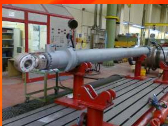
- Preberka hydraulických valcov z firmy Hunger určené pre plavebnú komoru v Gabčíkove.
