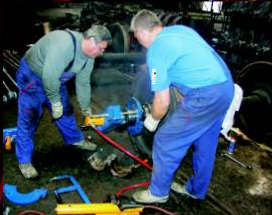
Sťahovanie vnútorných krúžkov vagónových ložísk a labyrintov -
